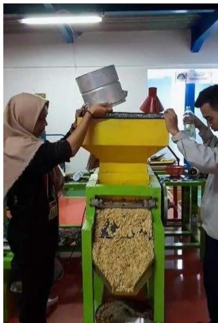
Gambar 7. Pengoperasian mesin pemisah kulit ari kedelai
