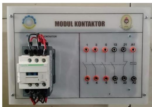
Gambar 5. Modul *Magnetic* Kontaktor
