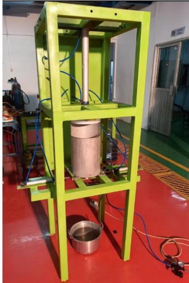
Gambar 5. Foto mesin pencetak bakso pneumatik
