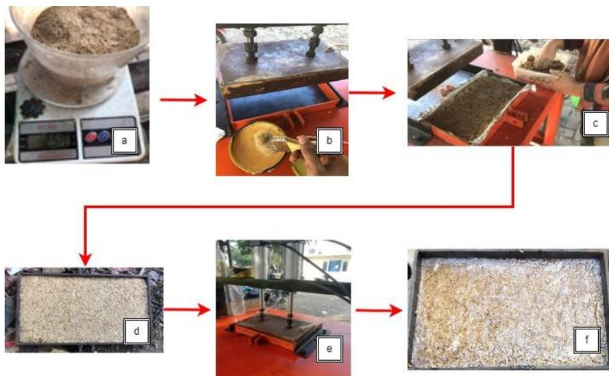
Gambar 5. Proses Pembuatan Produk *Particle Board*
